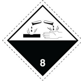
FIGURA 7.3.V Clase 8 — Sustancias corrosivas
